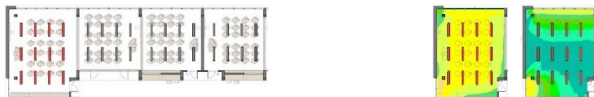
Fig. 5.62 Disposizione dei gruppi d'illuminazione, nelle aule didattiche di 77,5 m 2 , e valori di illuminamento con i corpi illuminanti accesi e spenti, in una condizione di cielo coperto
