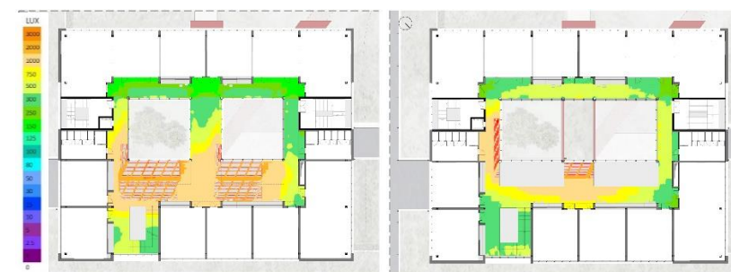
Fig. 5.54 Livelli di illuminamento degli spazi connettivi, al piano primo e secondo, in presenza della schermatura solare e nello scenario di cielo sereno al 21 giugno alle ore 17:00
