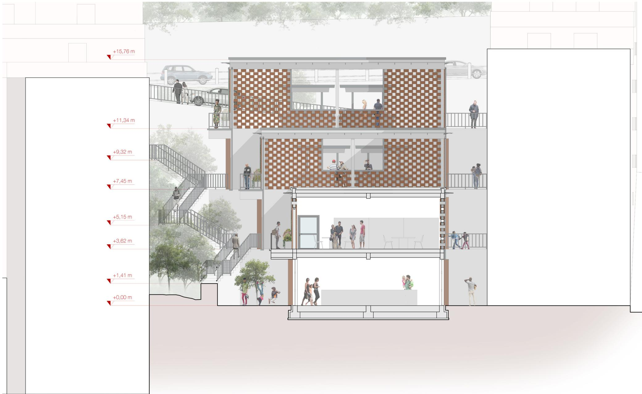
Figura 3.138 Sezione trasversale H - H edificio 3
