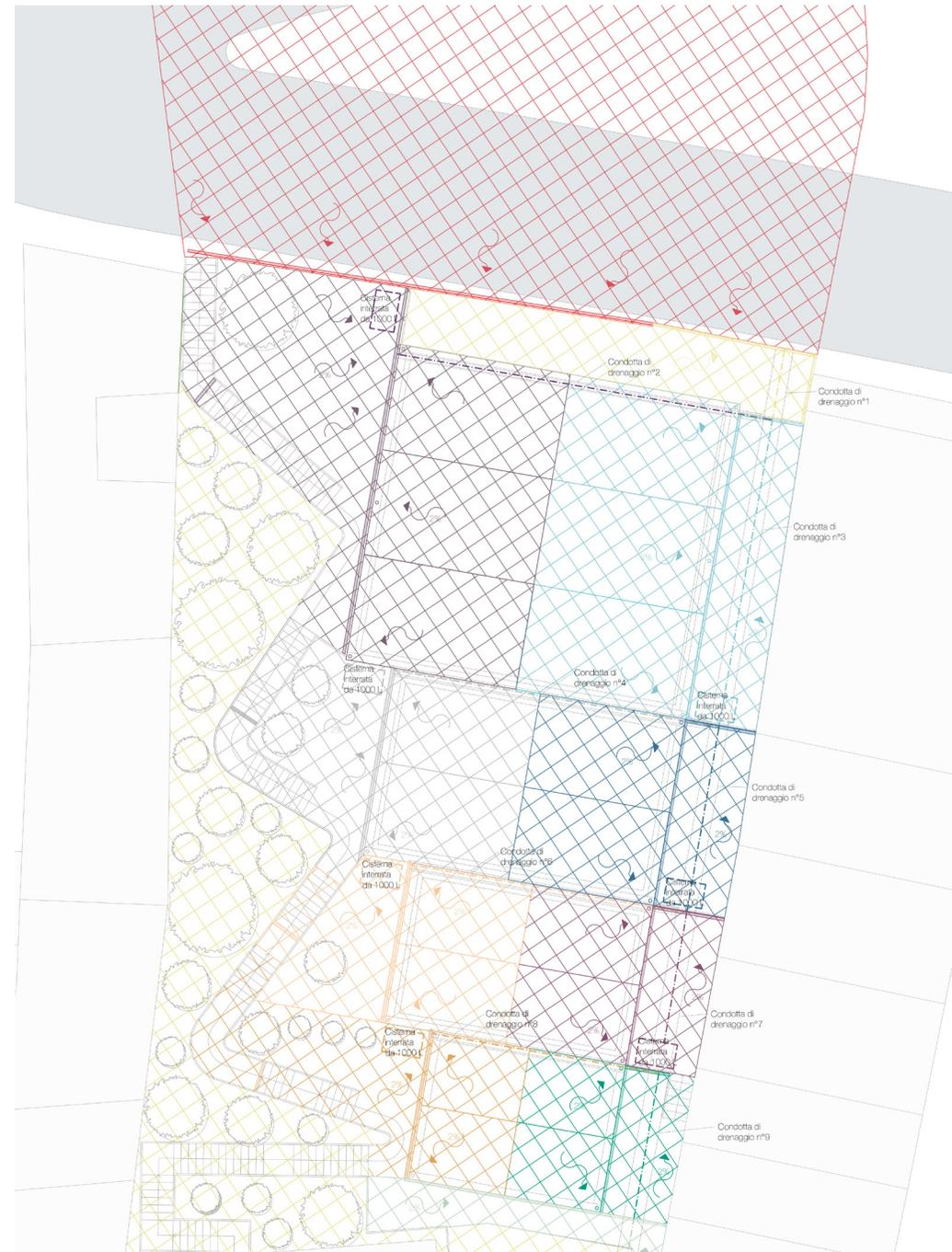
Figura 5.5 Sistema di drenaggio e relative superfici afferenti edificio 3
