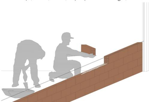
Figura 7.58 Illustrazione della posa dei mattoni (0,12x0,18x0,33)m per i tamponamenti, fase III
