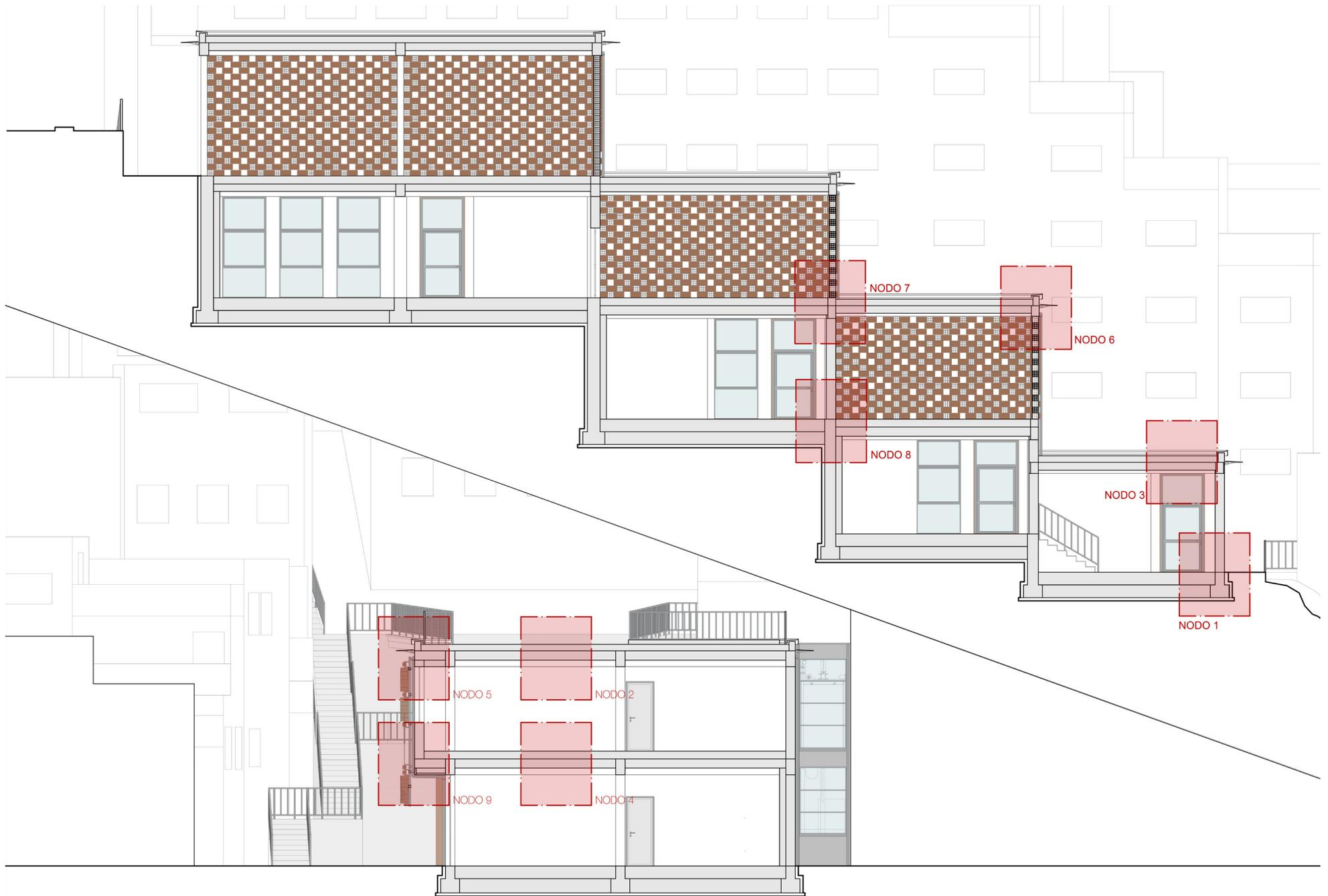
Figura 4.70 Sezione longitudinale e sezione trasversale con evidenziazione dei nodi
