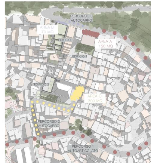
Figura 7.1 Schema di approvvigionamento dei blocchi Replast al cantiere
