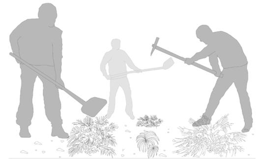
Figura 7.50 Illustrazione delle fasi di pulitura del piano di posa della muratura, fase I
