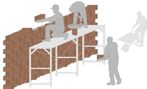
Figura 7.59 Illustrazione della posa degli elementi murari in quota, da ponte su cavalletti, fase III
