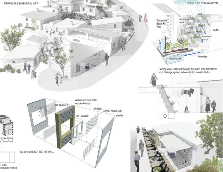
Figura 3.79 Local strategies for retrofitting in Derbent Slum Neighborhood, Istanbul, Turchia. (Interessante: Muro realizzato con bottiglie di detersivi in HDPE + muro drenante costituito da pneumatici all'interno dei quali sono alloggiate le piantumazioni).
