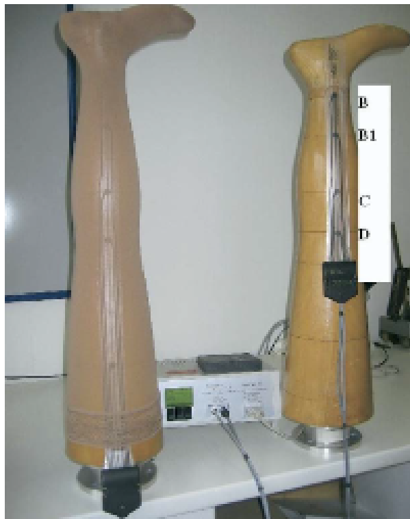
Figura 2.3: Nella gamba di sinistra si vede il dispositivo montato e nascosto dalla calza elasto compressiva. A destra invece si fornisce invece una rappresentazione del dispositivo e delle sue connessioni elettriche senza calza
