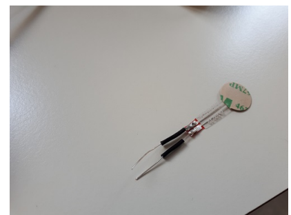
Figura 4.30: Sensore Peratech con saldati due prolungamenti di filo conduttore
