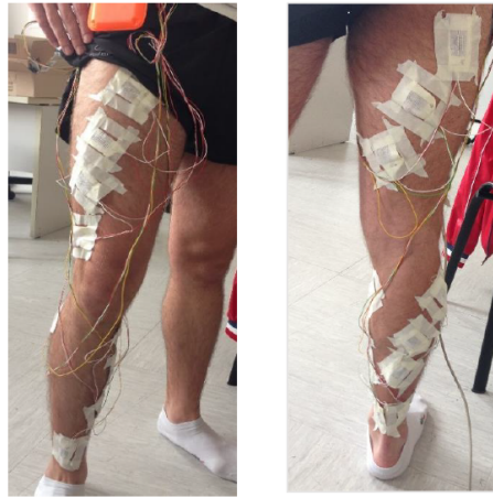
Figura 2.10: Posizionamento dei sensori con garze e fili su soggetto sano prima di indossare la calza
