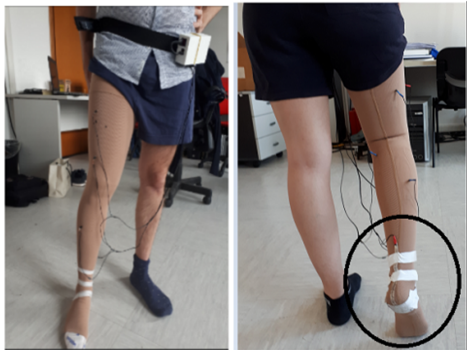
Figura 4.31: Dispositivo indossato in vita al soggetto con le apposite connessioni cavi-sensore
