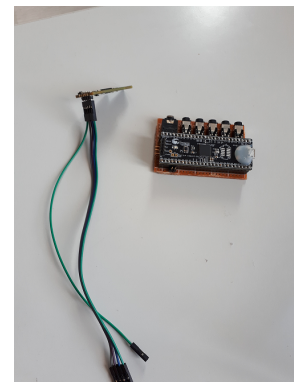
Figura 3.11: Cavi per effettuare collegamento Target con Programmer
