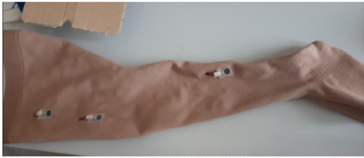
Figura 4.32: Disposizione dei sensori all'interno della calza primo setup sperimentale
