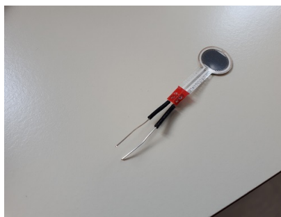
Figura 4.30: Sensore Peratech con saldati due prolungamenti di filo conduttore
