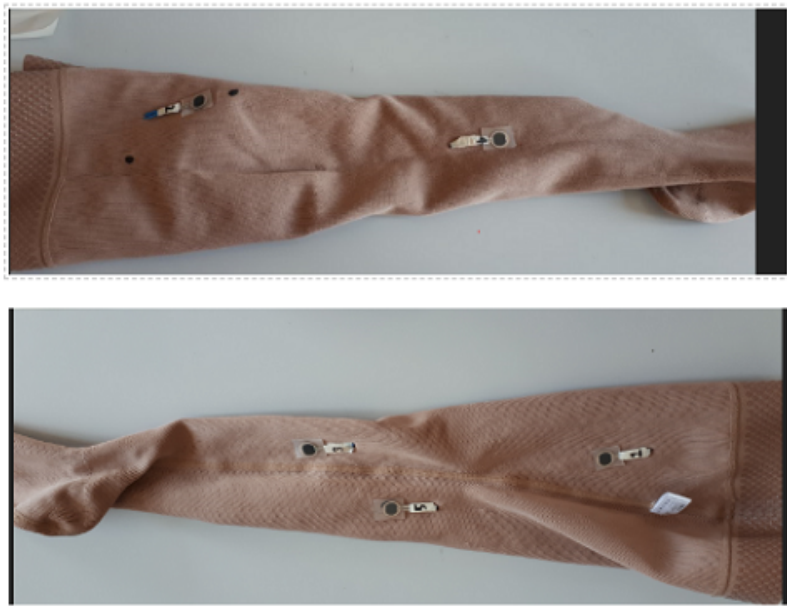
Figura 4.33: Disposizione dei sensori all'interno della calza nel secondo setup sperimentale
