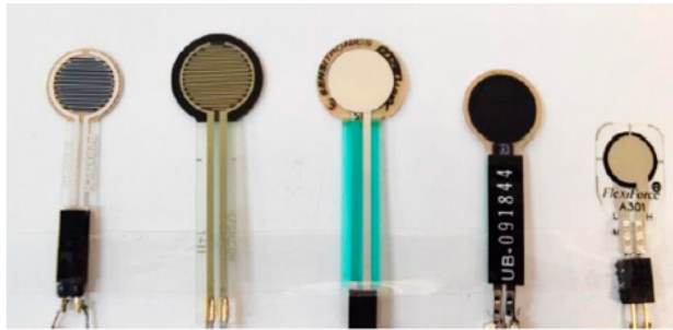
Figura 3.17: Sensori di forza resisitivi valutati(da sinistra a destra): Peratech QTC, Interlink FSR, Sensitronics FSR, sensore Tactilus e sensore Tekscan Flexiforce A301.
