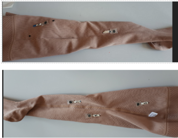
Figura 4: Posizionamento dei sensori all'interno della calza
