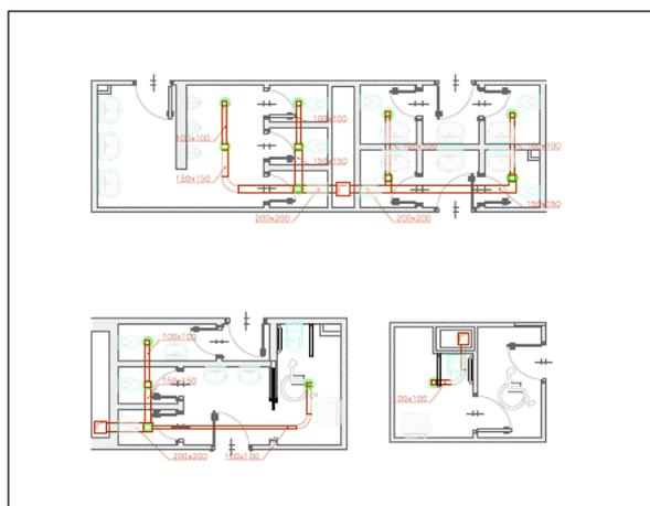
Figura 2.11 - Particolare dell'estrazione dei servizi igienici (piano terzo)
