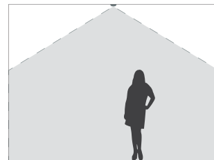
Illustrazione 3 - Raggio di azione di Microsoft Kinect
