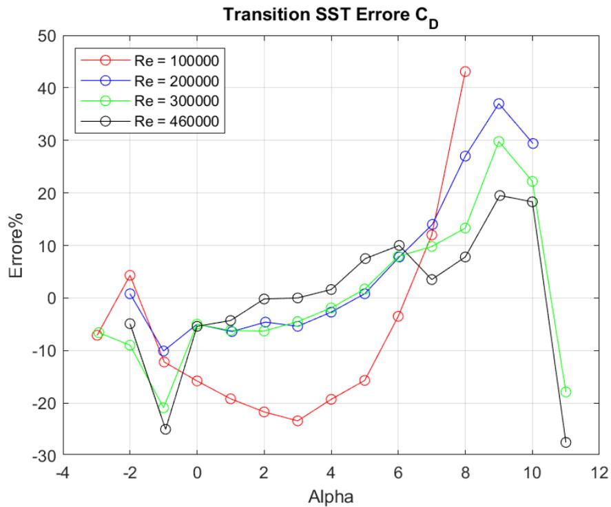
**Figura 181:** *Fluent Transition SST: Curva rappresentante l'errore (%) relativo al  $C_D$  in funzione dell'angolo d'attacco a differenti regimi di velocità*
