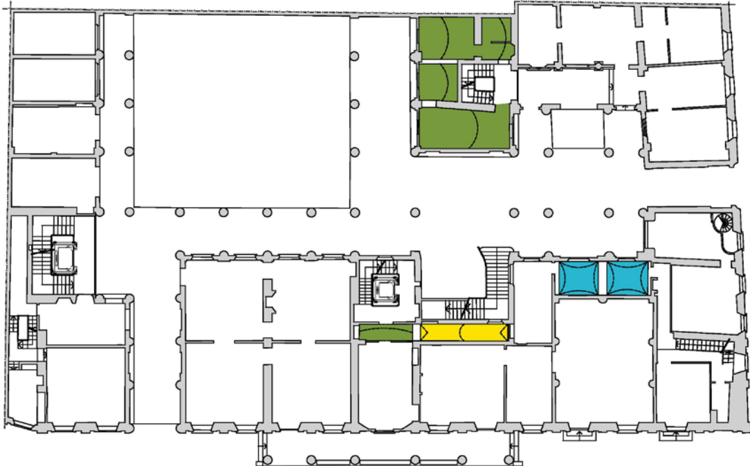
Tavola 36 - Tipologie di volte del terzo impalcato
