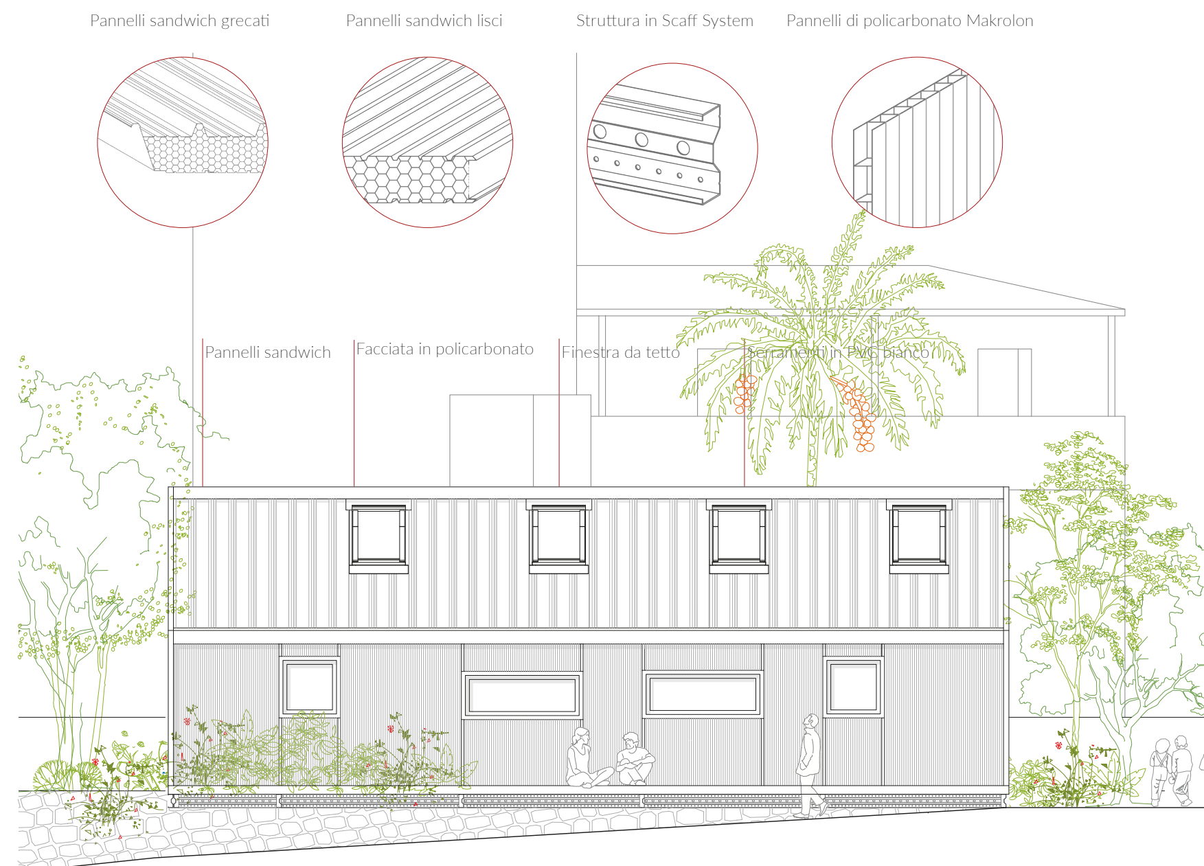
Figura 11.20. Abaco degli elementi utilizzati con vista del prospetto Nord scala 1:50
