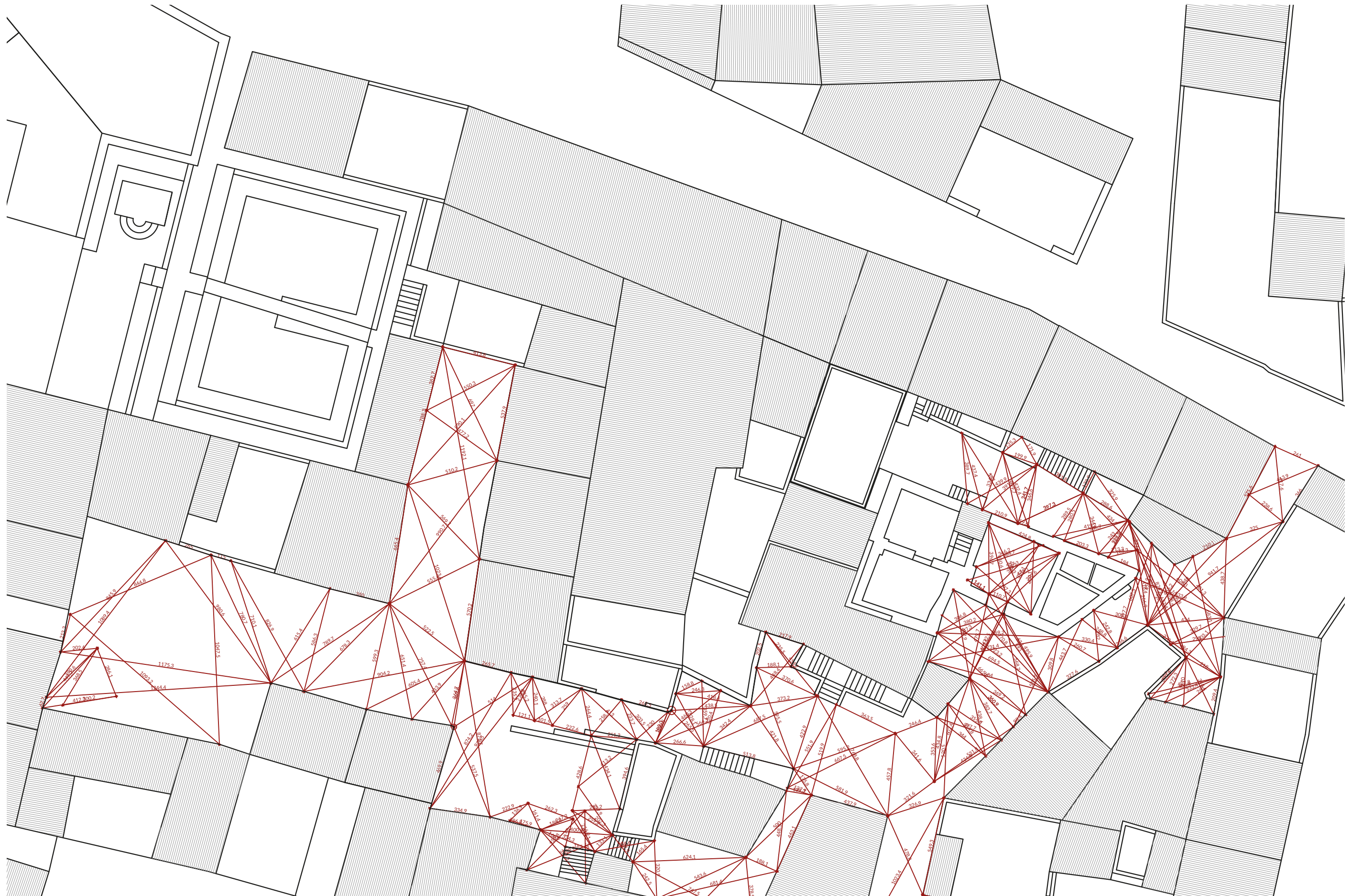
TAV.2.4 | RILIEVO PLANIMETRICO PER TRILATERAZIONI SCALA 1:200
