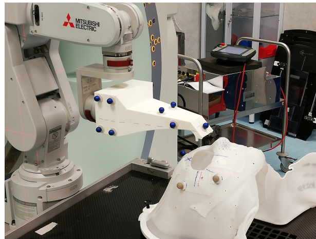
Fig. 1: Dispositivo ETS collegato al sistema di posizionamento (braccio robotico) e maschera termoplastica in sala TAC.
