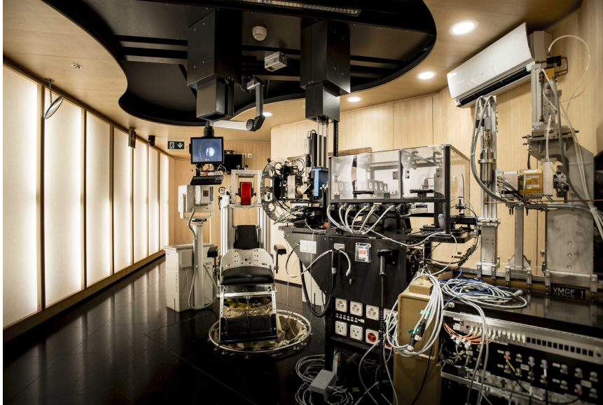
Fig. 11: Sala di trattamento adibita alla protonterapia oculare nel centro PSI (Paul Scherrer Institute) in Svizzera.
