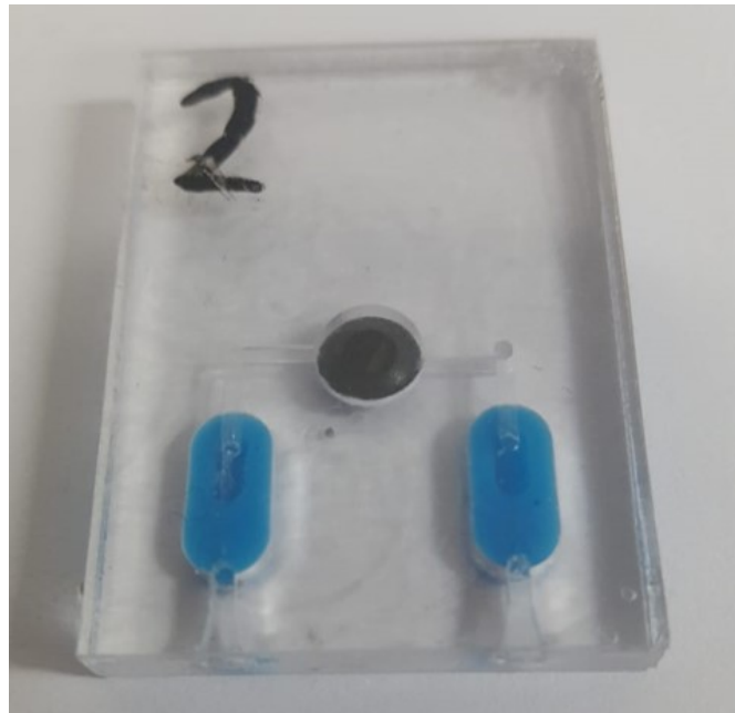
Figura 5.9: Esempio di cartuccia di prova per testare il terzo prototipo.
