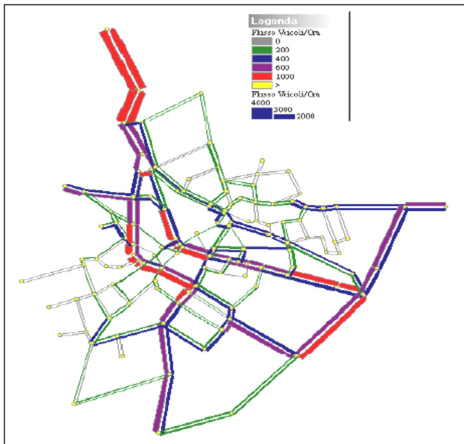
**Fig. 4.1.A.** Grafo assegnato o carico, risultato di una simulazione.
