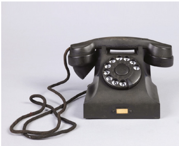
72. - Telefono Ericsson DBH 1001 in bachelite, progettato da Jean Heiberg per la Elektrisk Bureau di Oslo nel 1931
