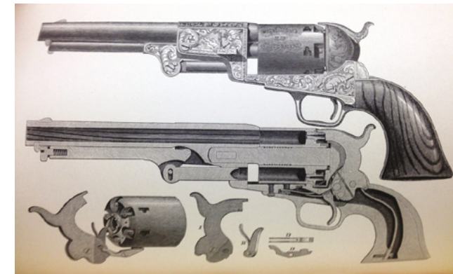
15. Vista frontale, sezione e componenti della rivoltella Colt
