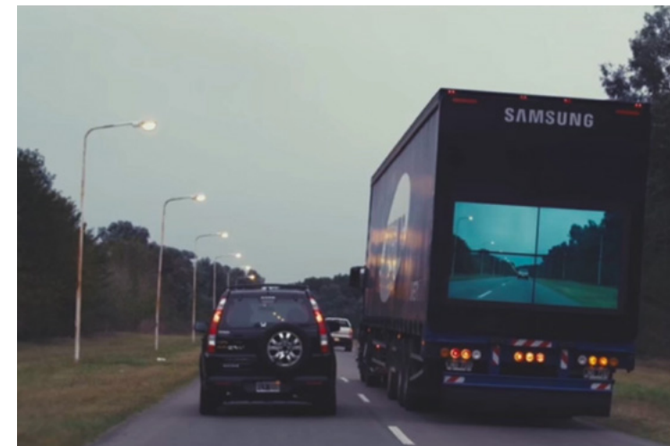
27. Samsung Safety Truck indica sui monitor che la carreggiata di fronte è libera per il sorpasso
