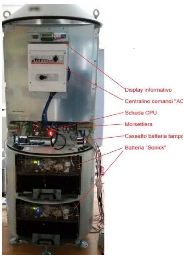
Figura 7.8 Vista lato AC e alloggiamento batterie
