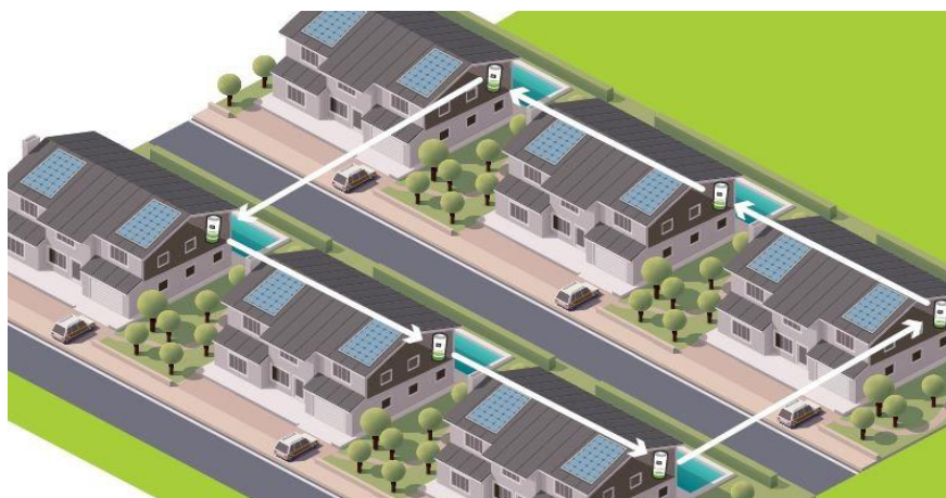
Figura 7.12 Smart grid con condivisione dei surplus energetici accumulati nei sistemi Zhero installati in diverse abitazioni
