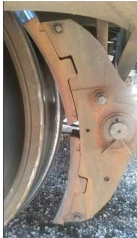
*Figure 3.5 (sinistra) e 3.6 (destra): Esempi di suole usurate. A sinistra, si nota la superficie rovinata; a destra, lo spessore ridotto*
