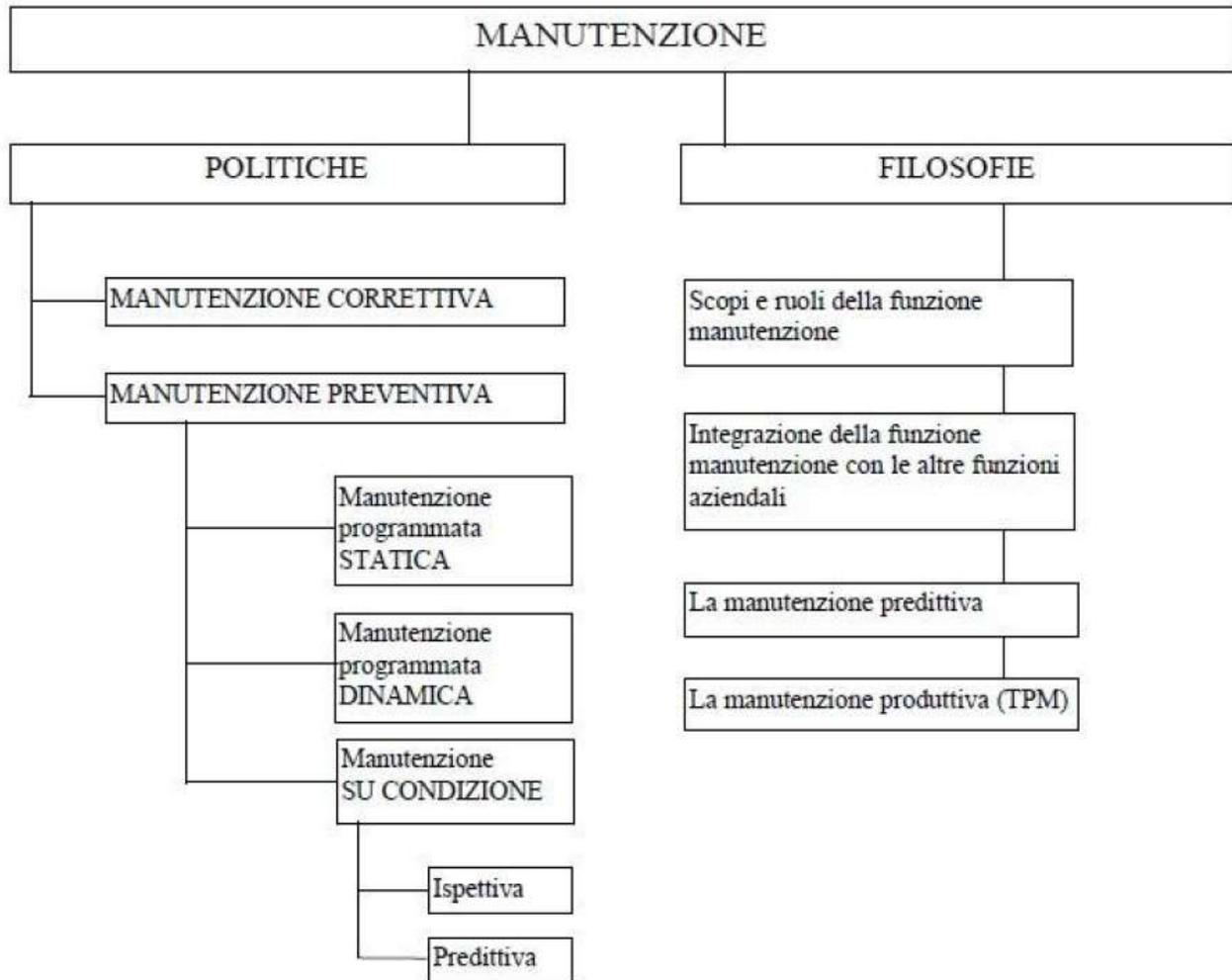
Figura 2.2: Schema delle diverse politiche e filosofie di manutenzione
