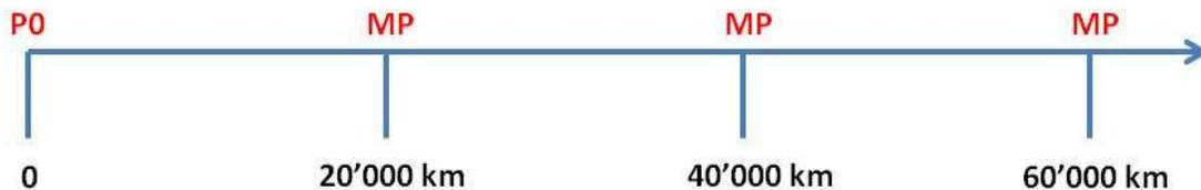
*Figura 6.5: schema del programma manutentivo definito per il cliente in questione, sulla base dei risultati ottenuti dall'applicazione del modello*
