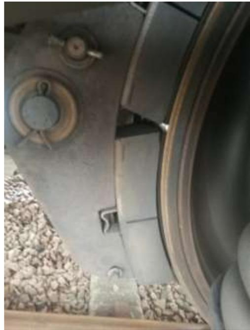
*Figura 3.4: Suole montate su un carro: ogni porta suole ne contiene una coppia. Quando il ceppo viene azionato, le suole entrano in contatto con la superficie della ruota*
