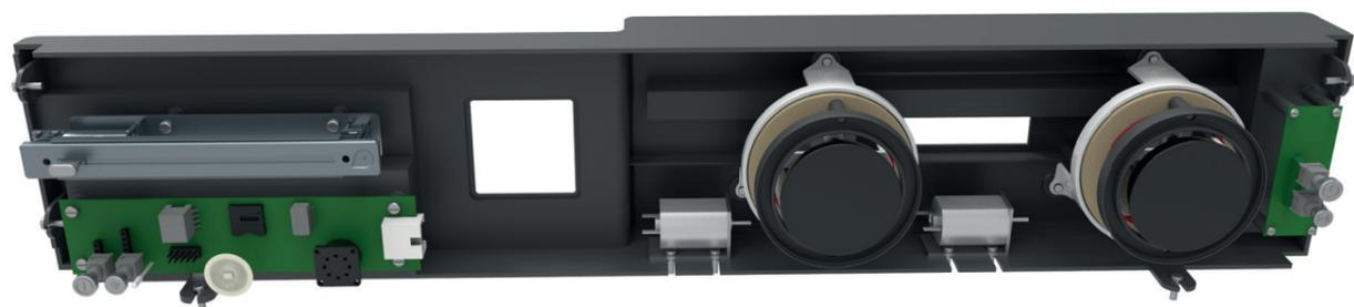
Ogni componente elettronico, come la PCB principale posizionata in basso a sinistra, la PCB del timer, il potenziometro lineare motorizzato, i due motori DC e i due sottoassiemi relativi alle manopole, sono alloggiati all'interno di una scocca di **PET rinforzato 30% Vetro** (Rynite 530 HTE NC010 - Dupont).
