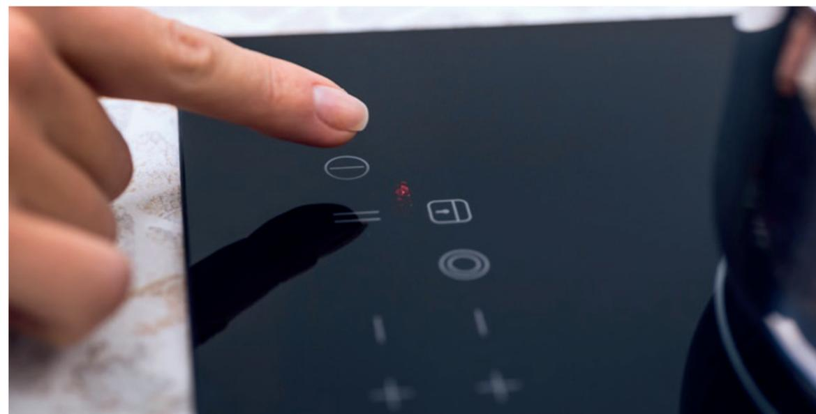
Fig. 40 : Pulsanti capacitivi touch su un piano cottura ad induzione. Fonte Caso Design.
