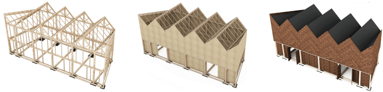
Figura 10.201: Modelli tridimensionali che mostrano il telaio in legno, l'isolante in lana di roccia e il rivestimento con porte; Fonte: https://www.archdaily.com/ ;
