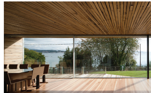
Figura 10.45: Il rivestimento in legno del soffitto è ricavato dal taglio interno degli assi in legno dei bateas ; Fonte: https://www.archdaily.com/ ;
