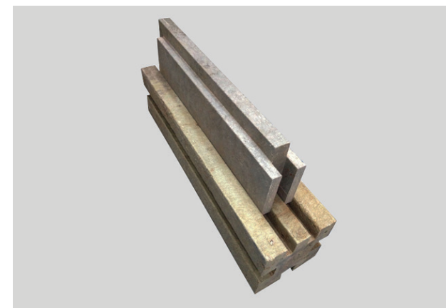
Figura 10.10: Il sistema costruttivo in mattoni di plastica riciclata; Fonte: http://observers.france24.com/ ;
