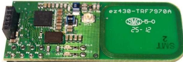
**Figura 2.34:** modulo del RFID transceiver ez430-TRF7970A UART utilizzato per comunicare mediante RF con il NFC tag basato sul RF430FRL152H. [14]
