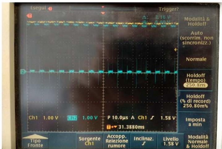
**Figura 4.5:** Stessi segnali visti nella figura 4.4 (Vout del TPS73133 in giallo e V1\_coil in blu/azzurro) ma è stata aumentata la risoluzione temporale per mostrare l'onda quadra da 160kHz.
