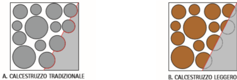
Figura 10 - Linee frattura calcestruzzo - Fonte [20]
