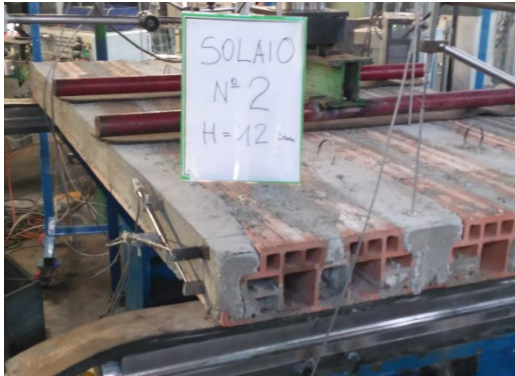
Figura 18 - Fotografia solaio SAP12
