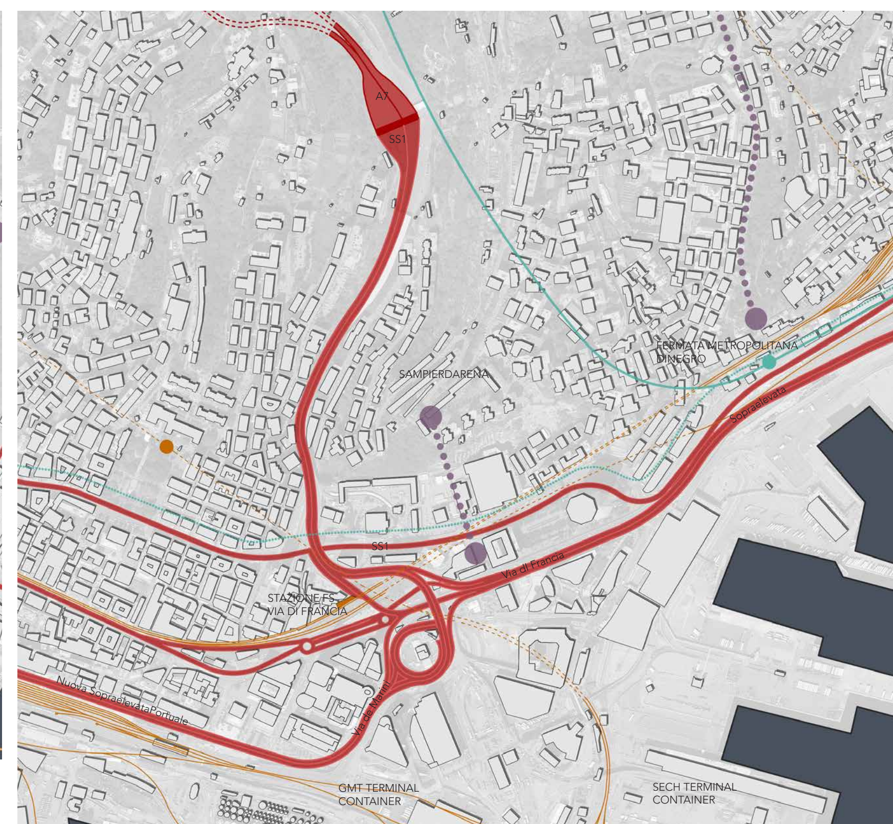
NODO DI SAN BENIGNO Unica Autostrada A2, collegamento viabilità statale SS1, Viabilità urbana - via di Marino (collegamento con Sopralavata portuale), via di Francia (Stazione FS), Viabilità portuale e commerciale: Terminal Container GMT e SECH, Impianto di risalita Sempredara, trasporto pubblico Metropolitano.
