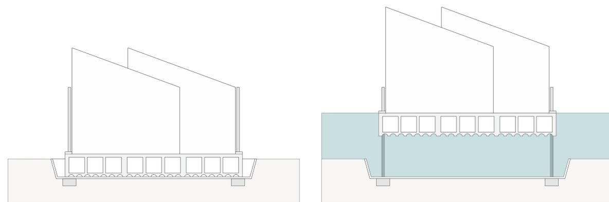
Schema funzionamento sistema di galleggiamento
