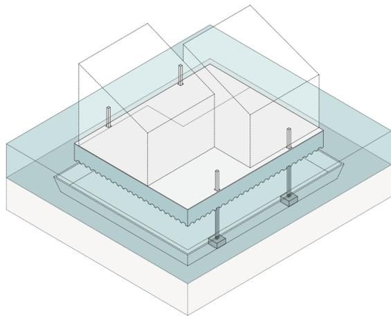
Schema funzionamento sistema di galleggiamento
