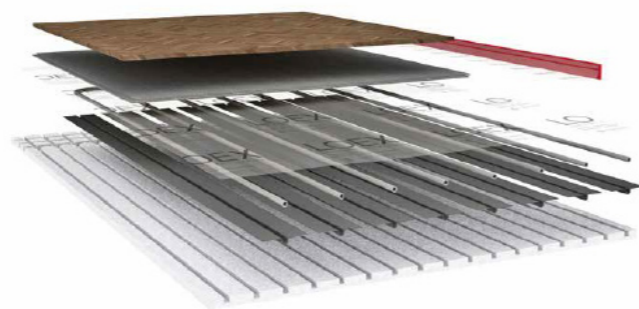
Fig. 5.4.36 Esplosione del sistema radiante a pavimento LOEX
