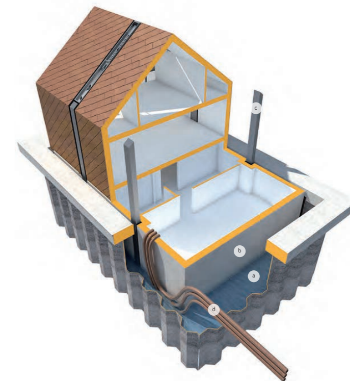
Fig. 5.4.21 Sezione assonometrica: componenti del sistema di galleggiamento
