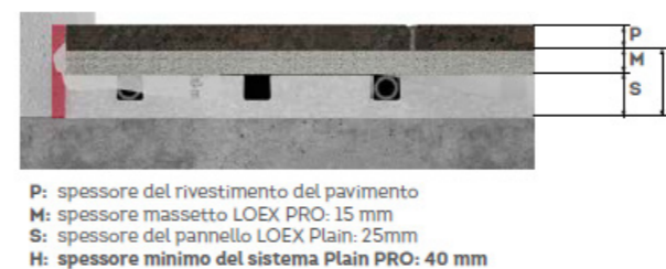
Fig. 5.4.37 Dettaglio sistema radiante a pavimento LOEX Home plain PRO
