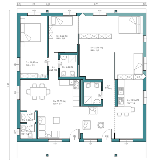
Fig. 5.3.36 Pianta modulo triplo con pareti aperte - variante 1. Scala 1:200
