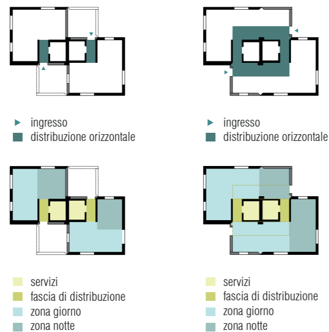
Fig. 5.4.1 Schemi: accessi e distribuzioni interne agli alloggi
