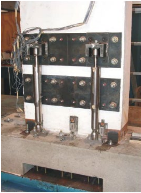
Figura 4-3: dissipatori collegati alla struttura in C.A. post teso. Fonte: [50]
