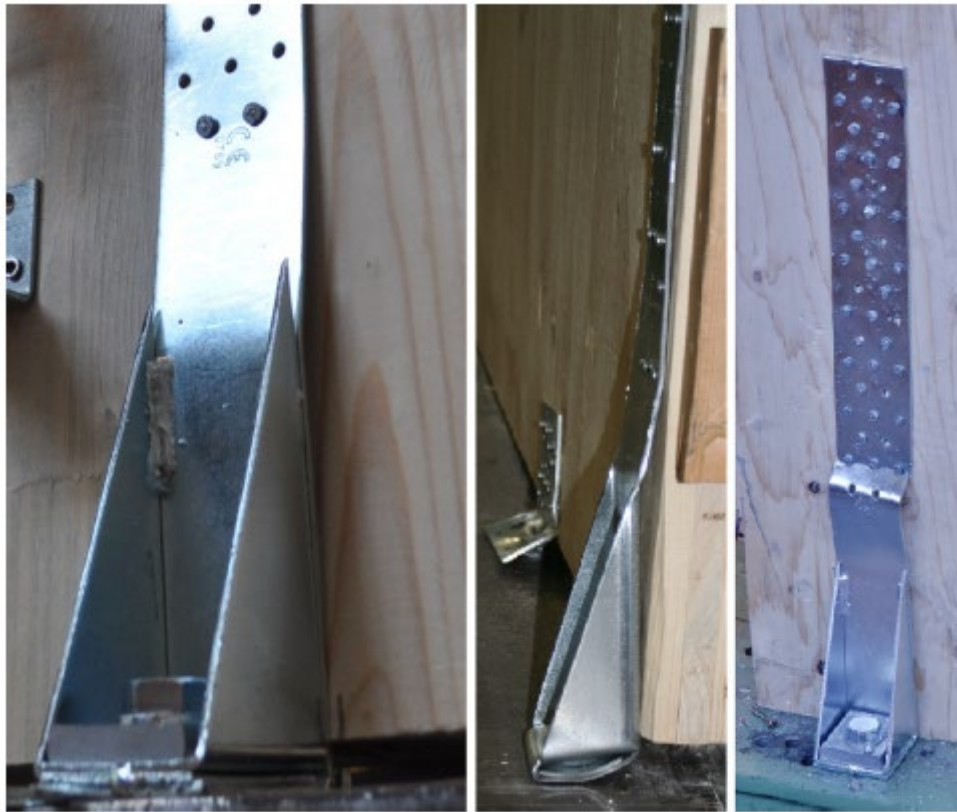
Figura 3-10: Bending nelle piastre metalliche degli HD. Fonte:[21]
