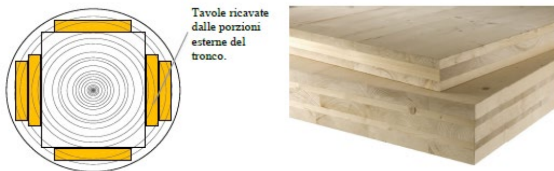
Figura 2-5: Tavole utilizzate per produrre i pannelli di CLT (a dx)
