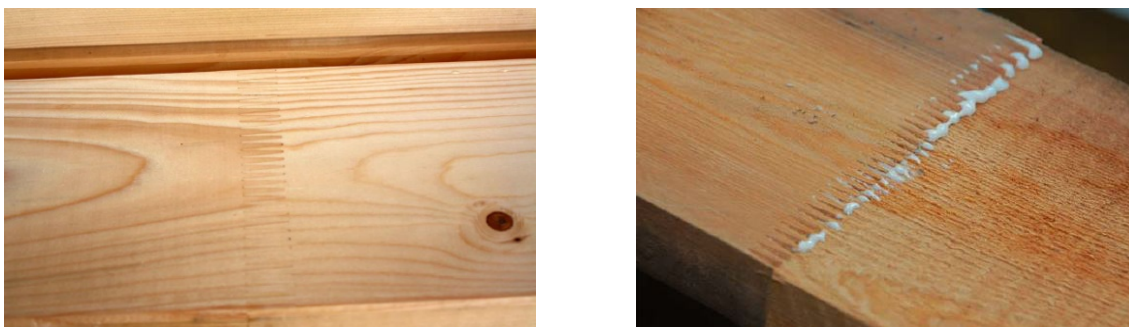
Figura 2-2: Giunti a pettine, realizzati di testa tra le lamelle.
