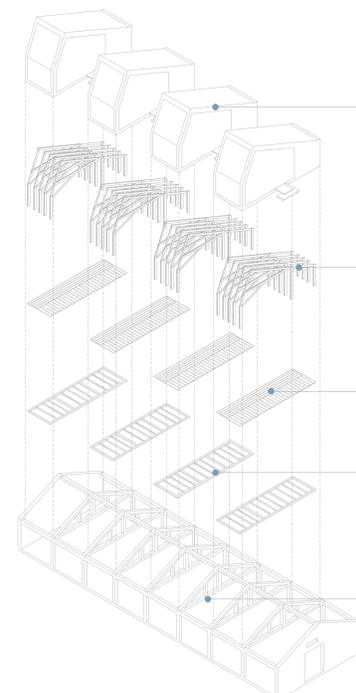
L'INVOLUCRO: IL RIVESTIMENTO DEL MODULO ABITATIVO E REALIZZATO IN VETRO E IN LEGNO CON UNA FACCIATA VENTILATA. NELLE PARETI E' PREVISTO UNO STRATO ISOLAMENTO IN FIBRA DI LEGNO
