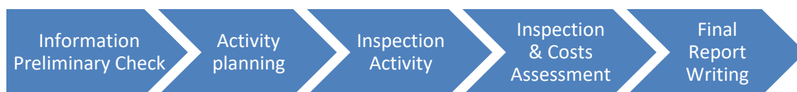
Figure 17 – Flow chart summary about the main due diligence phases. Source: own elaboration based on the phases of Paganin, G. (2005). L'Acquisizione delle Informazioni per la Manutenzione per i Patrimoni Immobiliari .
