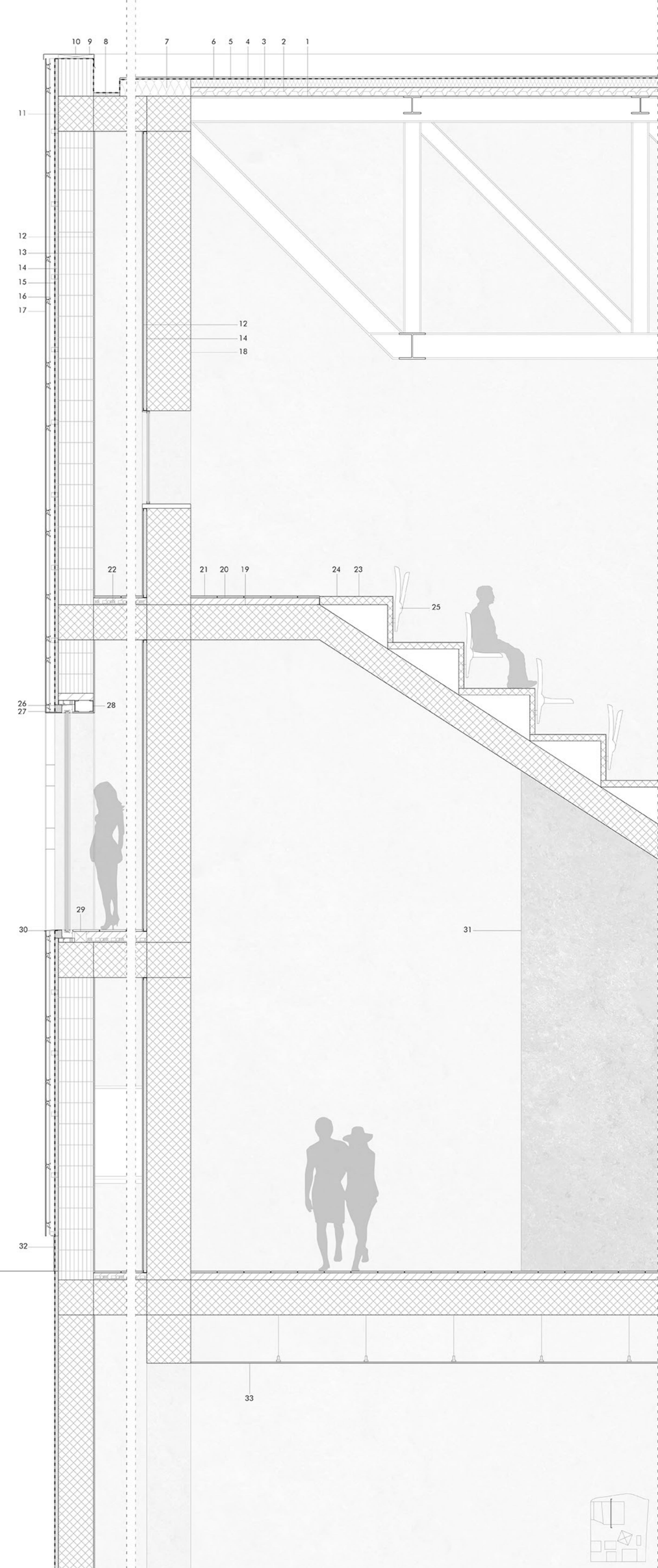
1. trave reticolare h 3m L 57m, saldata in cantiere
