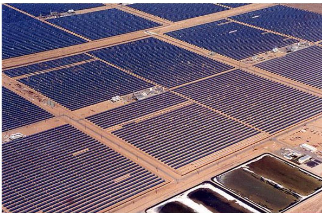
Figura 24 - La centrale californiana SEGS (Solar Energy Generating Systems) con i suoi 354 MW è la più grande al mondo.
