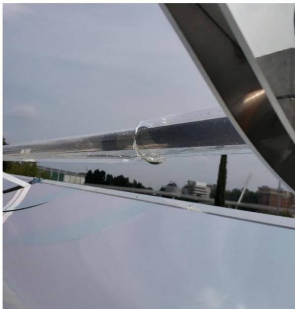
Figura 37 - Esempio di problematiche derivanti dai fenomeni di dilatazione e compressione termica.
