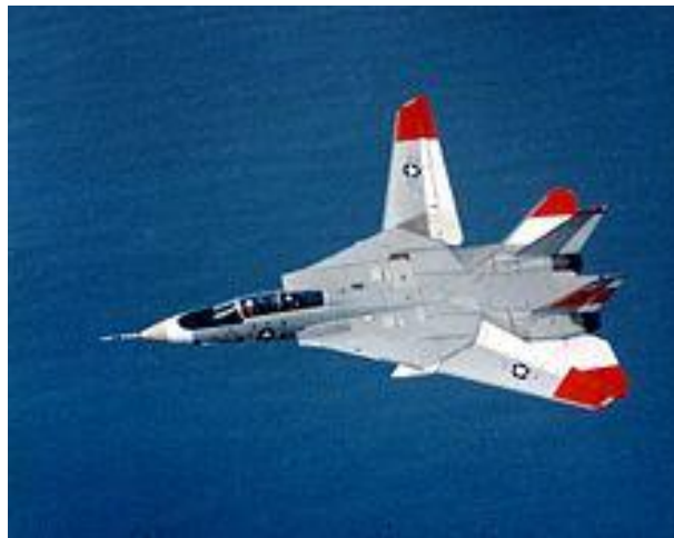
Figura 1.3: Grumman F-14 Tomcat, ala a freccia variabile
