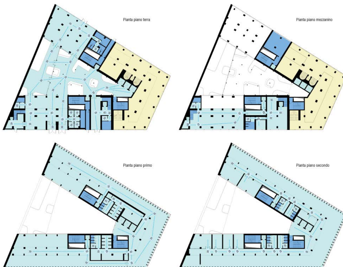
Figura 87: Tavola di accessibilità piano terra, mezzanino, primo e secondo
