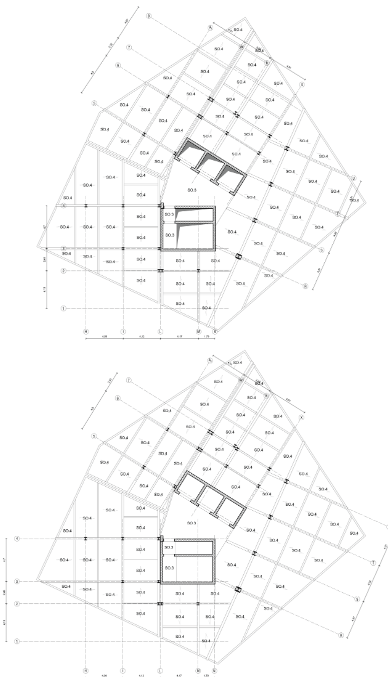
Figura 83: Pianta strutturale impalcati decimo e copertura
