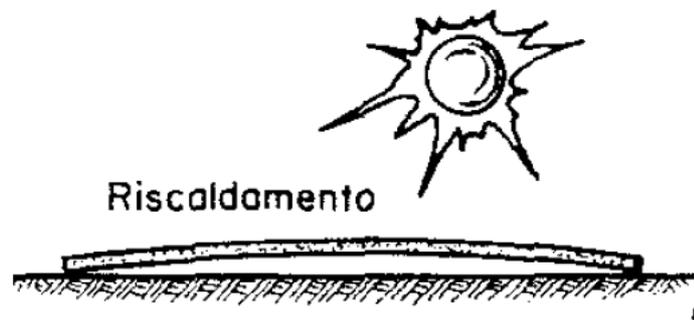
Figura 64: Comportamento della pavimentazione causato dal riscaldamento
