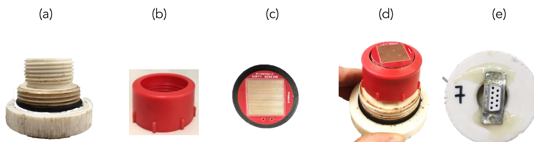
Figura 2.5 - (a) Tappo in PVC con doppia filettatura; (b) contro-tappo per alloggiamento sensore; (c) sensore dotato di O-ring per la tenuta idraulica del tappo; (d) configurazione tappo; (e) connettore per la misura di impedenza
