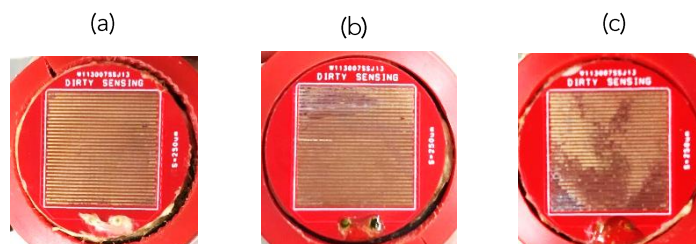
Figura 3.28 – Sensori di sporcamento DS al termine della seconda prova di sporcamento organico: (a) 8, (b) 9, (c) 10
