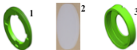
Figura IV: Sistema per gli accessi laterali. 1) Elemento filettato per comprimere il cilindro di silicone interposto con degli alloggiamenti per l'utensile per l'avvitamento. 2) Cilindro di silicone da interporre. 3) Elemento filettato da incollare al corpo principale dell'atrio rigido e con la superficie d'appoggio per il cilindro di silicone.
