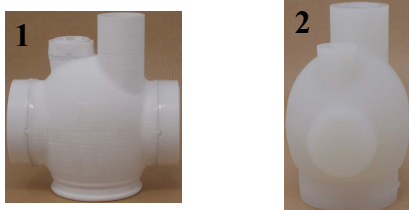
Figura VI: 1) Versione rigida in PLA. 2) Versione flessibile in PRO-LASTIX 20.
