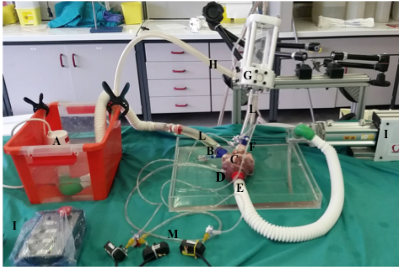
Figura 3.29: Set-up complessivo per la prova sperimentale con il cuore naturale. A) Precarico attivo: Reservoir e pompa continua centrifuga Osculati 800 immersa all'interno. B) Connettore tra il precarico e l'atrio naturale, ha un accesso per un trasduttore di pressione del precarico (P_Precarico) ed uno per una videocamera. C) Cuore naturale di suino. D) Accesso per il trasduttore di pressione ventricolare (P_Ventricolo). E) Connettore apicale per applicare la pompa pistone pulsatile al cuore animale. F) Connettore in uscita dall'aorta, ha un accesso per un trasduttore di pressione aortico (P_Aortica). G) Post-carico RCR per replicare la circolazione sistemica. H) Tubo di ritorno al precarico attivo A. I) Pompa pistone pulsatile e pulsantiera per azionarla. L) Tubi sui quali applicare i flussimetri (Q_Precarico e Q_Aortica). M) Trasduttori di pressione.
