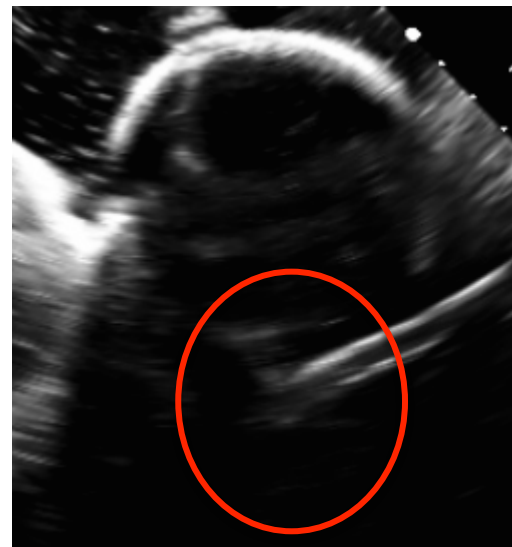
Figura 3.6: La valvola mitrale all'interno dell'ovale rosso non è visibile con l'atrio rigido in PLA. (Ecografia 2D)
