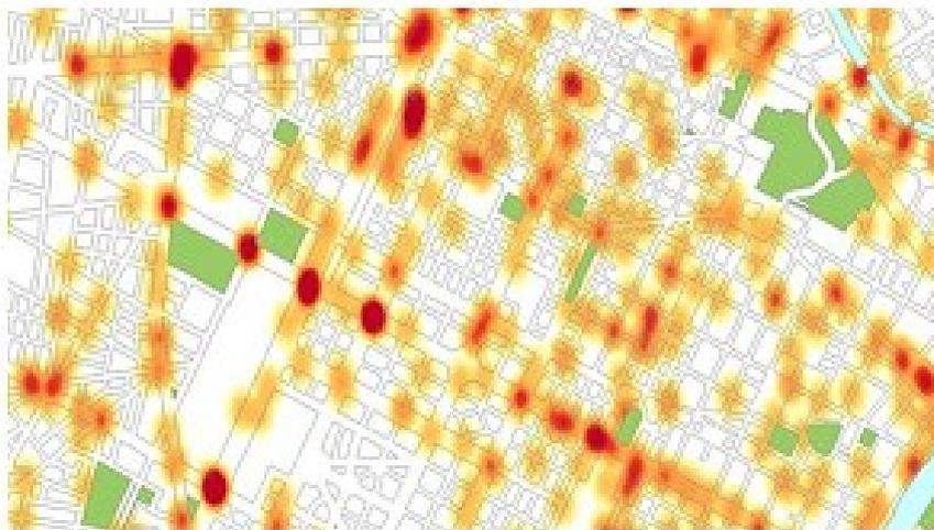
*Figura 25: esempio di mappa di calore realizzata tramite il plug-in di QGIS heatmap che permette di applicare la KDE. La scala di colore che va dall'arancione più chiaro al rosso ricalca la precedente suddivisione di valori.*
