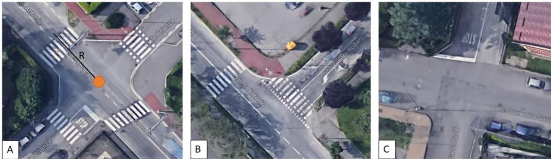
Figura 48: esempio di a) attraversamento completo (C), b) attraversamento non completo (M), e c) attraversamento non presente (N). (fonte Google Maps)
