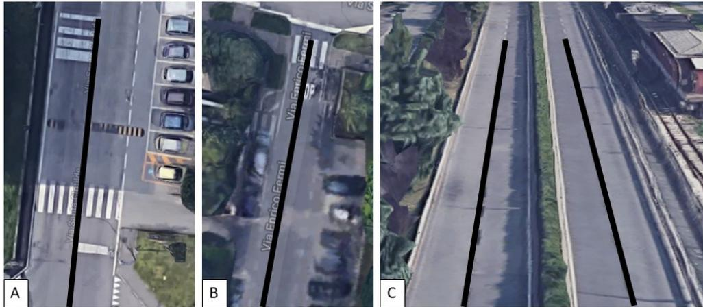
Figura 36: esempio di rappresentazione degli archi (linea nera) ed esempi di uso della categoria “numero di corsie” e “senso di marcia”. Immagine a) 1 arco con 2 corsie doppio senso, b) 1 arco 1 corsia senso unico, c) 2 archi ciascuno con 2 corsie a senso unico.
