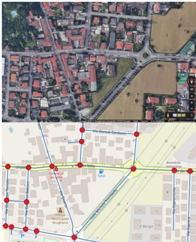
Figura 32: esempio di rete stradale. Nell'immagine in alto si denota un'area della città di Brugherio (MB), Italia (fonte Google Maps) mentre in basso la stessa area ma come rete di calcolo con archi (linee blu) e nodi (punti rossi).
