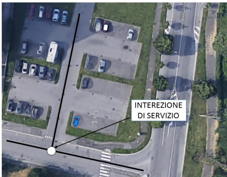
Figura 44: esempio di uscita di servizio (E) formata tra due archi F e la strada di uscita da un parcheggio (S).
