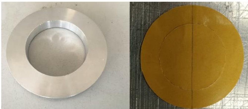
Figura 21 - Dima per la produzione degli anelli di preimpregnato
