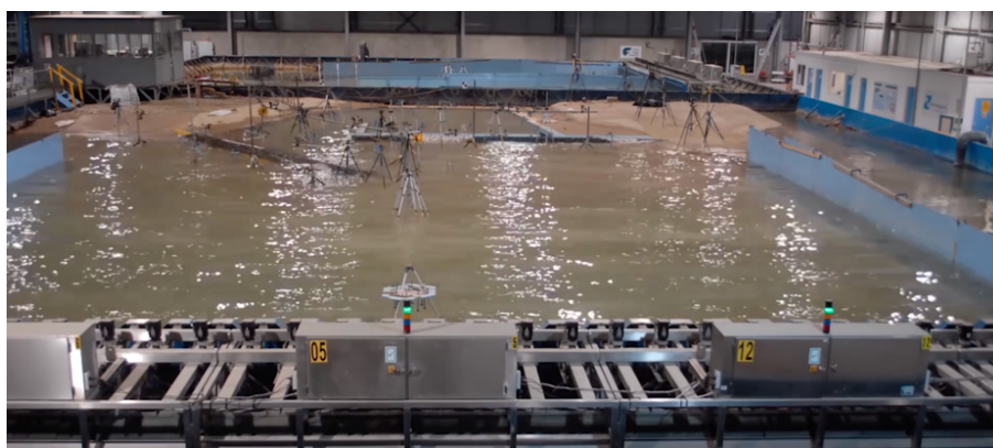
Figura 25 - Esempio vasca con generazione di onde 3D in funzione con sonde di livello - (www.hrwallingford.com 2017)
