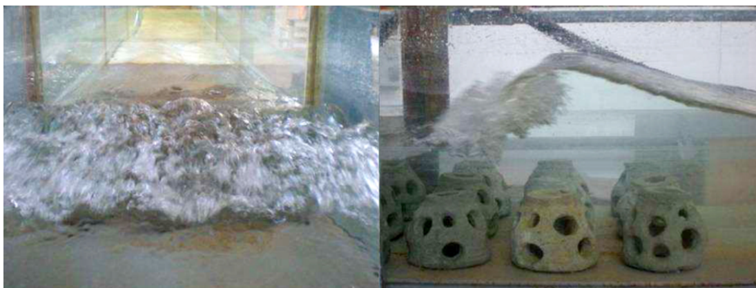
Figura 65 - Esempio modello fisico Reefball in laboratorio - (Del Vita 2016)
