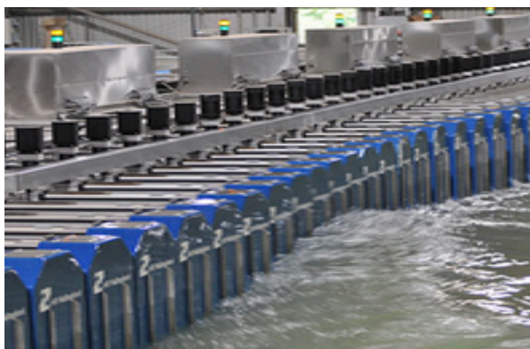
Figura 30 - Esempio generatori d'onda 3D del tipo a pistone - (www.hrwallingford.com 2019)
