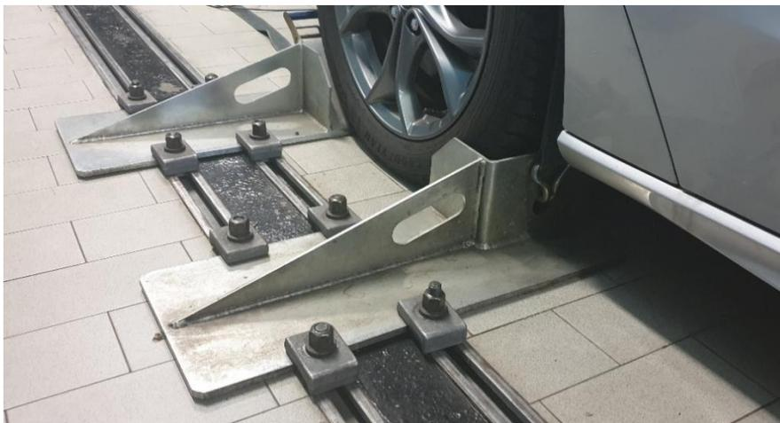
*Figura 16 - Blocchi con cinghia che immobilizzano le ruote non motrici a terra.*
