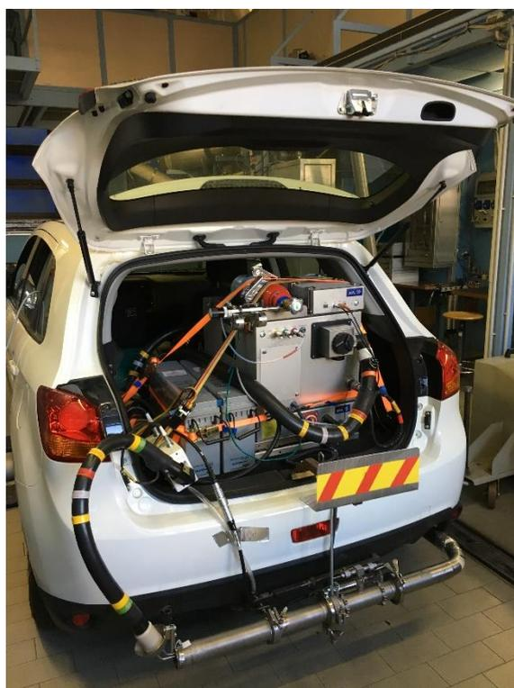
Figura 48 – Strumentazione PEMS a bordo di un'autovettura per l'esecuzione di una prova RDE.
