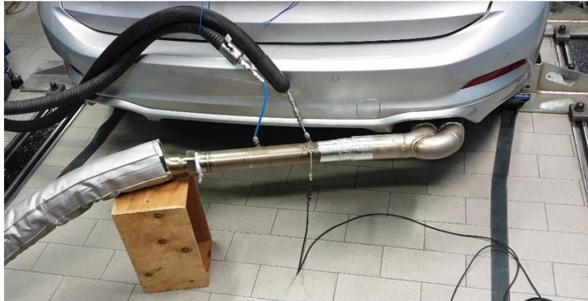
*Figura 17 - Connessione tra il tubo di scappamento dell'autovettura e il tubo di raccordo del gas di scarico.*
