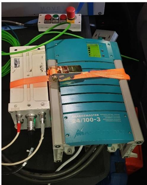
Figura 44 - Mastervolt Chagemaster 24/100-3 (a destra) e AVL M.O.V.E EFM Control box (a sinistra).
