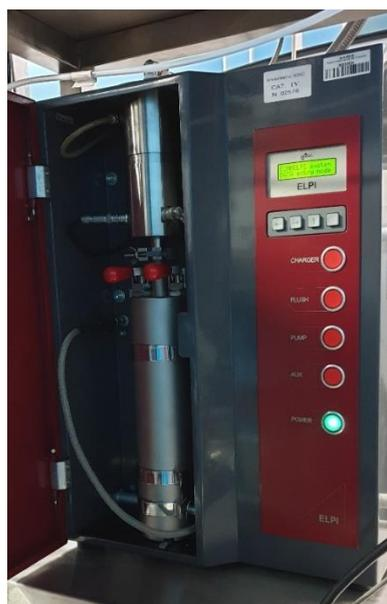
Figura 29 – Impattore elettrostatico a bassa pressione.
