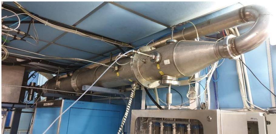
Figura 20 - Tunnel di diluizione.
