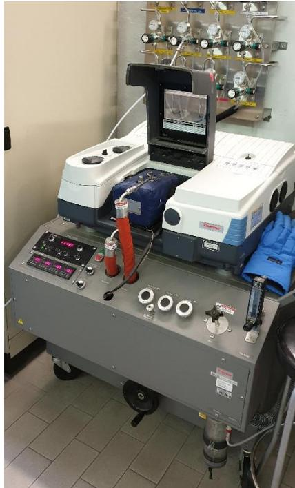
*Figura 32 - Spettrofotometro infrarosso a trasformata di Fourier.*
