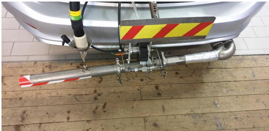
Figura 43 - Exhaust Flow Meter da 2,5" di diametro.
