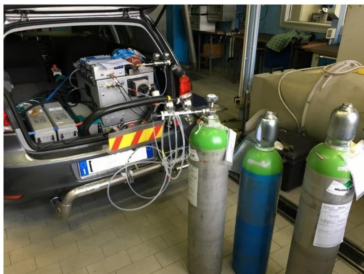
Figura 38 - PEMS durante la fase di calibrazione tramite gas contenuti in bombole certificate.
