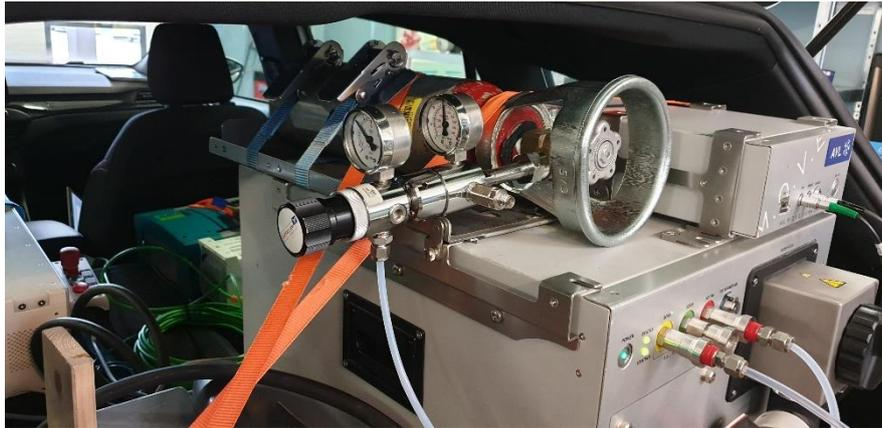
Figura 41 - Bombola con miscela di H<sub>2</sub> (40%) e He (60%) di alimentazione della fiamma del FID.
