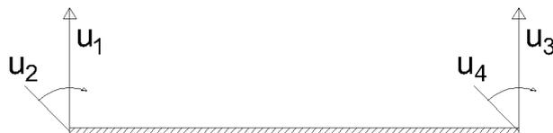
**Figura 3.2:** gradi di libertà locali di ogni elemento
