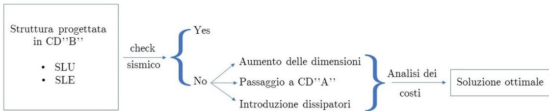
**Figura 2.15:** progettazione concettuale di una struttura
