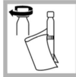
3. Tappare la cuvetta, pulire bene la cuvetta esternamente.
