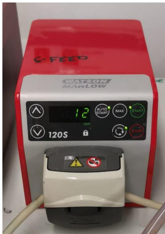
**Fig. 3.12** Pompa di carico dell'influente
