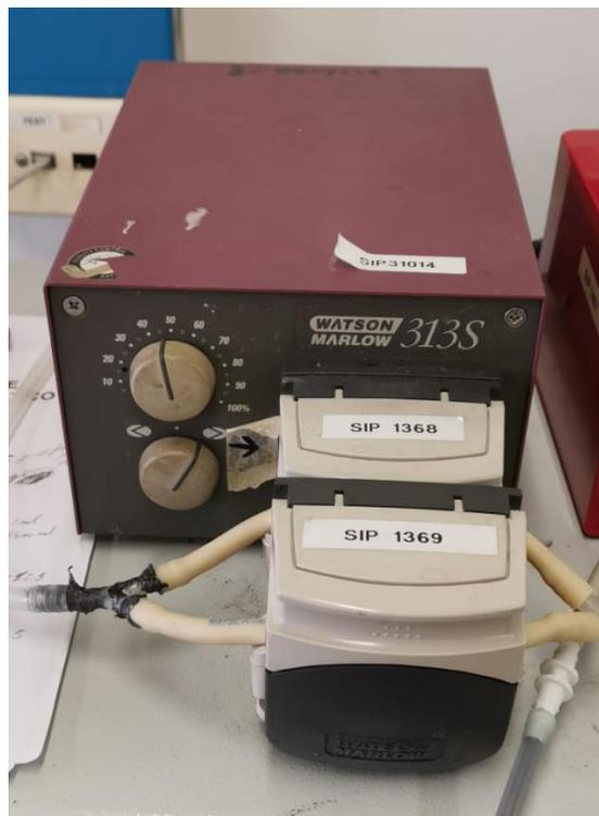
**Fig. 3.10** Pompa peristaltica utilizzata per il ricircolo del gas nel reattore
