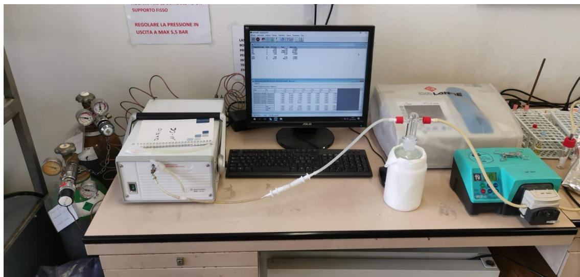
**Fig. 3.19** Il gascromatografo
