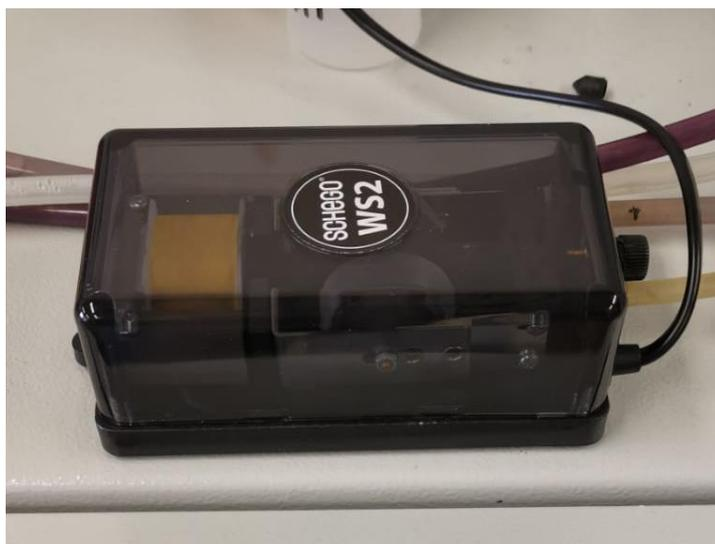
**Fig. 3.11** Compressore per l'insufflazione di aria nel reattore
