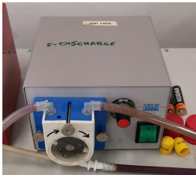
**Fig. 3.13** Pompa di scarico dell'effluente
