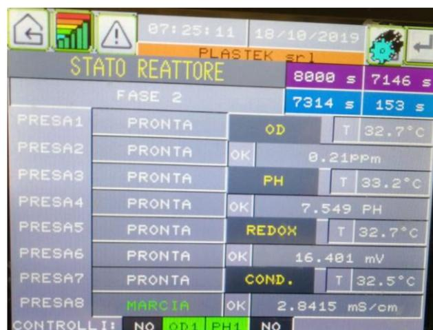
Fig. 3.5 Pannello di controllo dello stato del reattore
