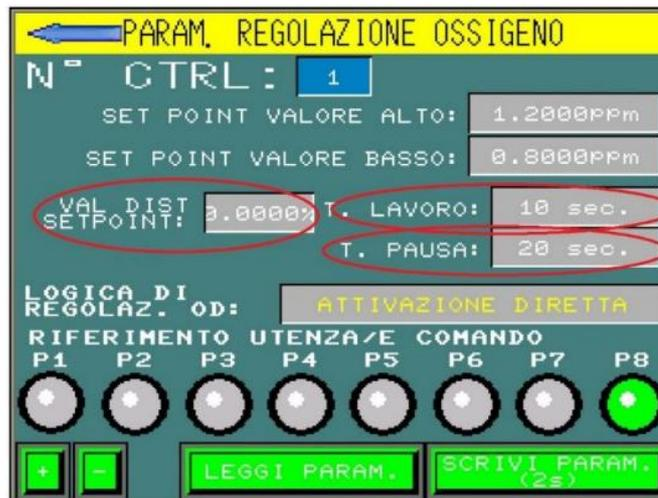
**Fig. 3.8** Schermata del PLC per l'impostazione della modalità di lavoro del compressore
