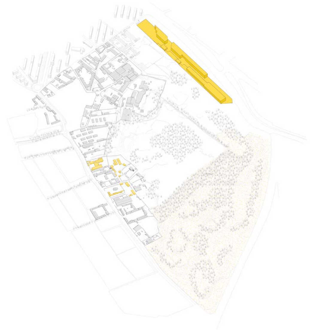
Figura 04. In evidenza i volumi da costruire, gli spazi per il riciclo di materiali (lungo via San Dionigi), i manufatti da dismettere (in grigio chiaro) e l'area dell'ex-discarda da bonificare
