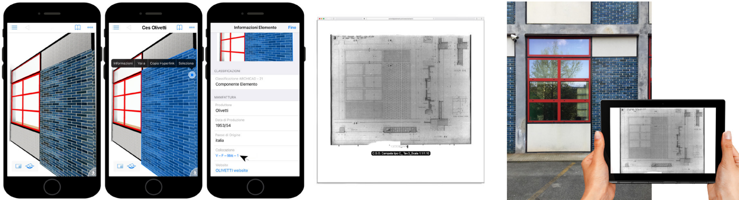
Fig.12: Screenshot dall'applicazione BimX , visualizzazione del disegno d'archivio tramite la selezione dell'oggetto scelto e supporto informativo utilizzabile in loco.
