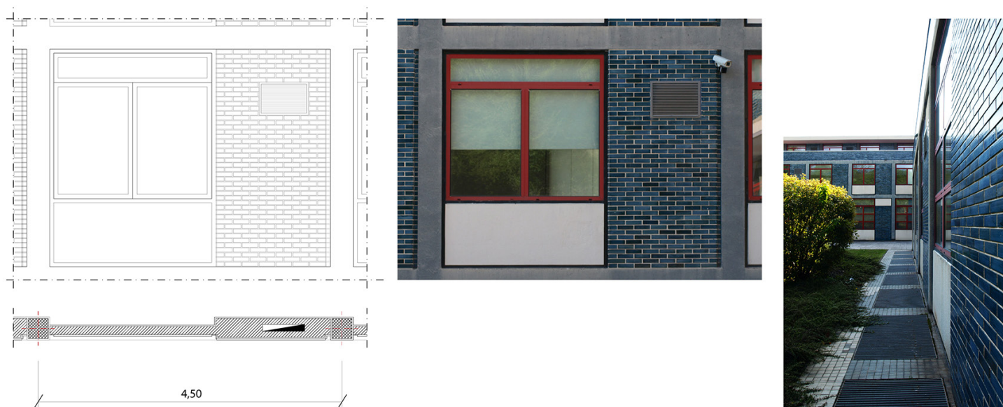
Fig.7: Immagini in alto: esempio di ridisegno dei moduli di chiusura; nel caso specifico modulo B caratterizzante i piani alti lato disegnatori, il fotoraddrizzamento del modulo e una fotografia che evidenzia lo scarto tra la struttura e il tamponamento.
