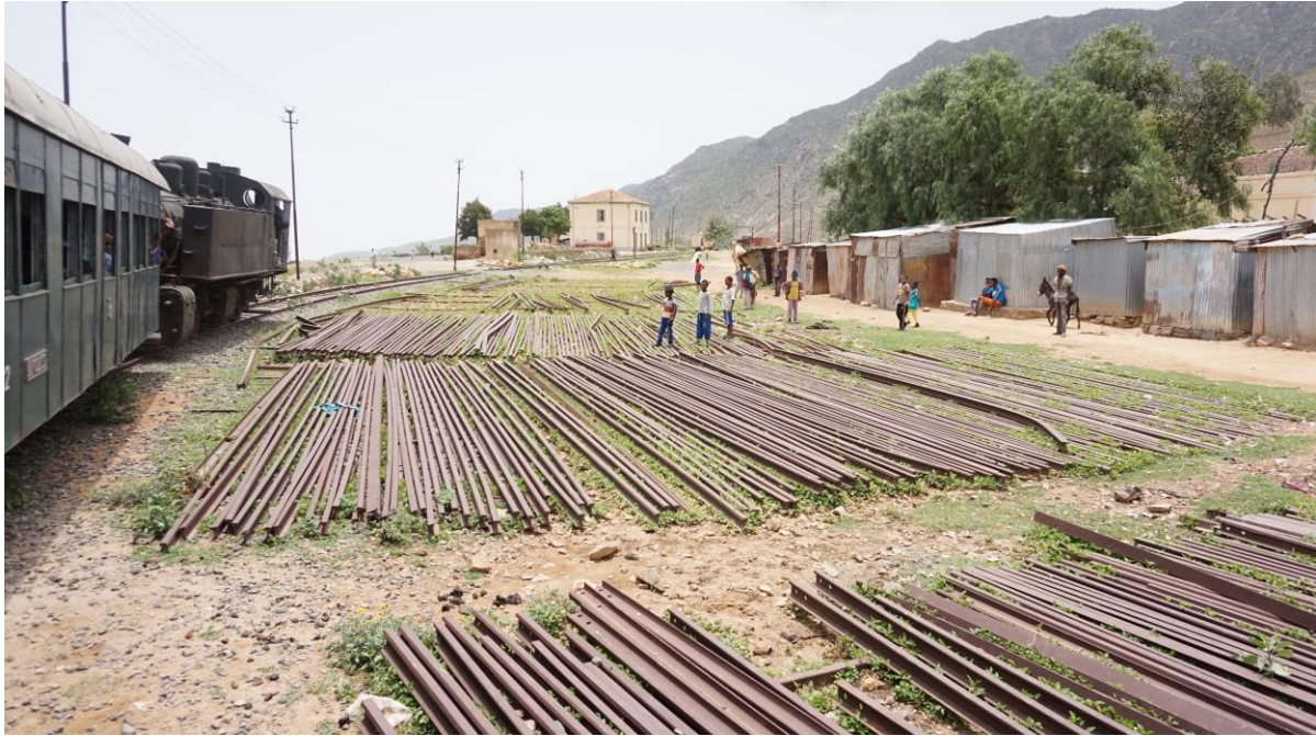
Il deposito di rotaie recuperate e rettificare nella stazione di Nefasit (foto 2018).
