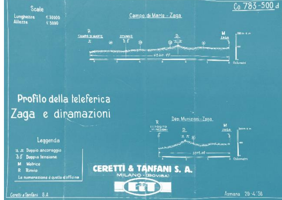
Profilo della Teleferica Zaga e diramazioni (Ceretti&Tanfani S.A. Milano-Bovisa Co. 783-500d Asmara 29-4-36, scale lunghezze 1:30.000, altezze 1:5.000), in ASD-MAE ASMAI volume III, busta 67
