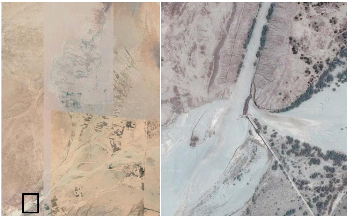
Lo sbarramento di Uachiro. Anche in questo caso si può constatare che il serbatoio è ormai saturo (immagini satellitari da Gmap).
