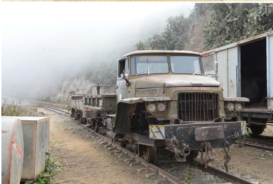
Uno dei due locomotori realizzati dagli abili meccanici ferroviari alla fine degli anni novanta con mezzi di recupero, presso la fermata ferroviaria di Arbaroba (foto Dawit Abraha 2018).
