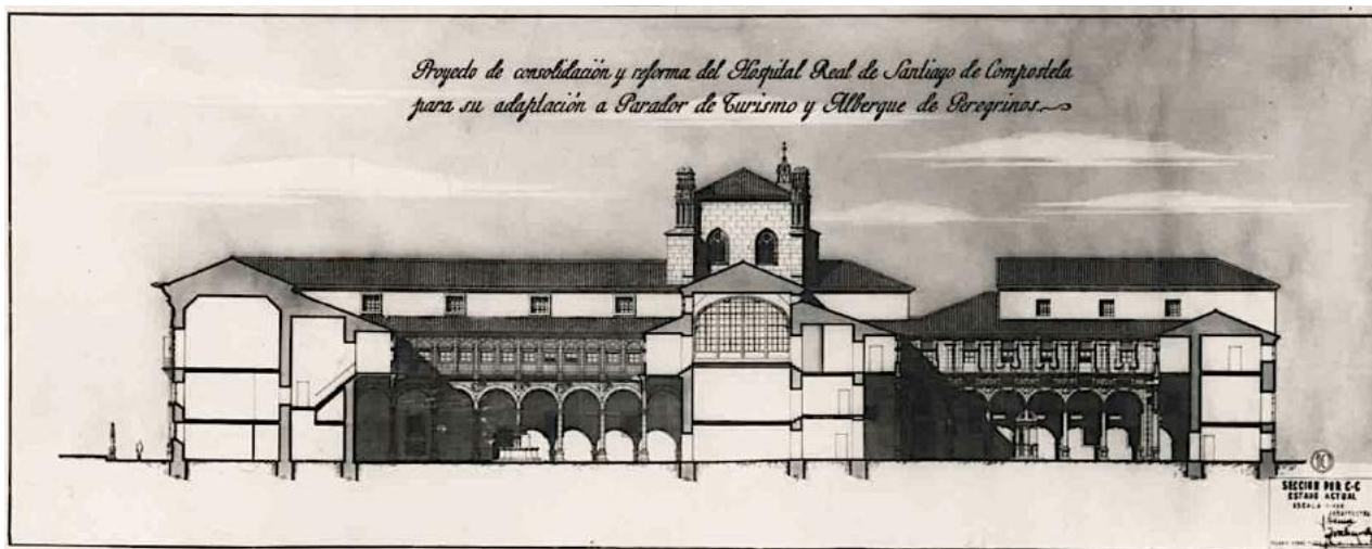
Imagen 3.- Proyecto de consolidación del Hospital Real de Santiago de Compostela para su adaptación a Parador de Turismo y Albergue de Peregrinos. Sección CC. Estado Actual, 1952. Fuente: A.G.A. TOP-22-03-CA-22079-010
