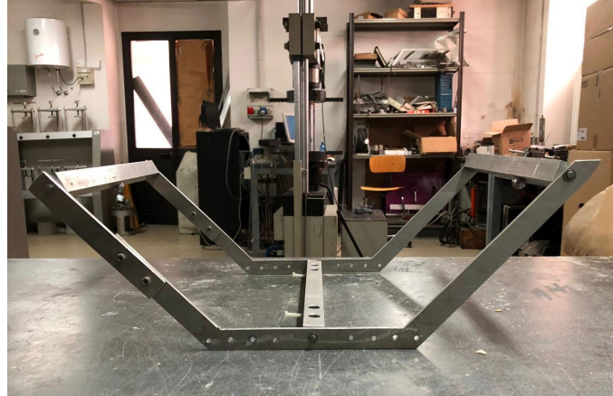
Figura 3.19: Telaio metallico "Gondola" per il supporto degli LVDT verticali
