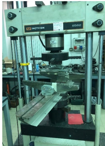
Figura 3.13: Pressa Instron munita di lame di carico e di appoggio per l'esecuzione della prova di flessione su quattro punti
