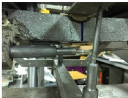
Figura 3.16: LVDT posizionati secondo la configurazione di prova
