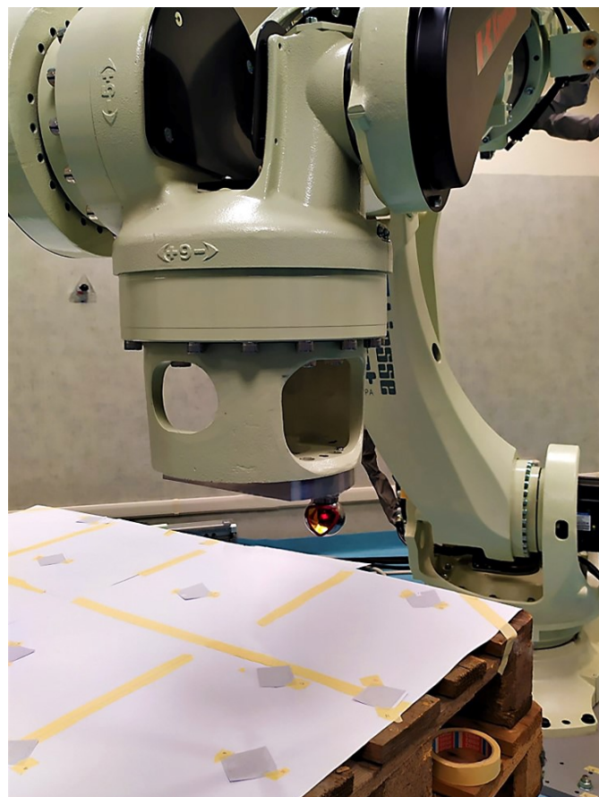
Figura 3.6: Acquisizione dati con manipolatore in approccio semi-manuale presso Sala Simulazione di CNAO. Il robot è mosso nel volume tramite Teach Pendant. La SMR è posizionata a bordo del manipolatore.
