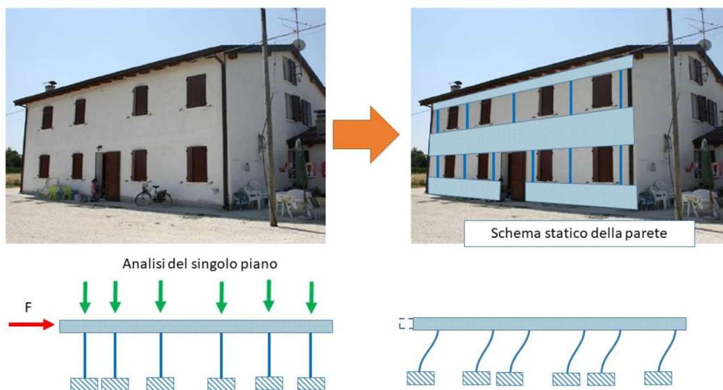
*Figura 5.1 Esempio di schema statico di una parete in muratura con metodo POR [10]*
