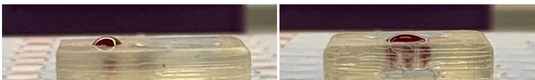
Figura 48: Immagine laterale e frontale del dispositivo che mostrano la capacità della valvola capillare di trattenere solo il volume di sangue necessario per il test.
