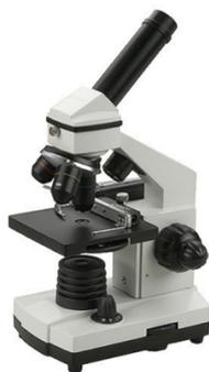
Figura 24: Immagine del microscopio ottico utilizzato per le analisi di rugosità superficiale.
