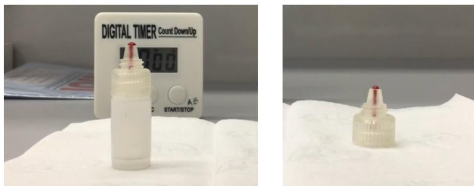
Figura 43: Immagini che mostrano la capacità del tappo capillare di mantenere all'esterno della configurazione il volume di sangue in eccesso depositato all'imboccatura del componente.
