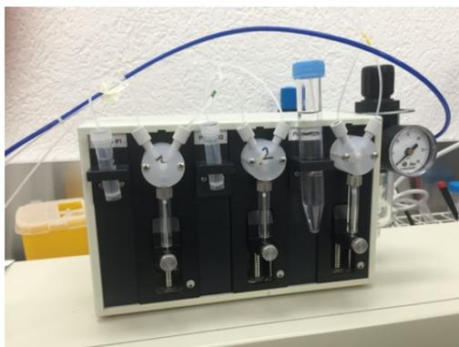
Figura 29: Dettaglio relativo alle tre pompe utilizzate dall'*IsoFlow Dispenser* per la semina delle strisce reattive.
