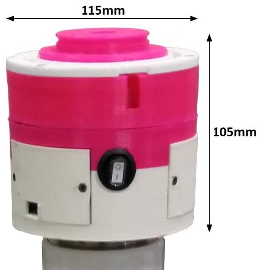
Figura 4.6: Il sensore di carico realizzato.
