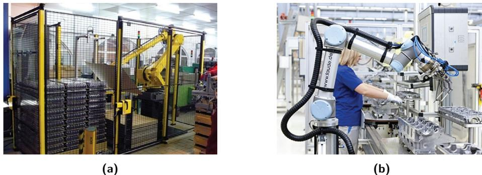
**Figura 1.4:** Spazio di lavoro di un robot convenzionale (a) e di un robot collaborativo (b) [6].
