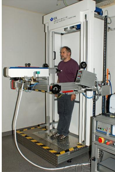
**Figura 2.6:** Impianto di prova con algometro per la determinazione delle pressioni massime esercitabili sulle diverse aree corporee [12].
