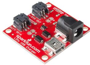
**Figura 3.27:** Caricatore LiPo MCP73831/2 della Microchip Technology.
