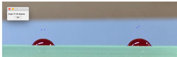
Figura 25: Immagine che rappresenta due gocce di sangue depositate sulle lastre stampate in SLA. L'immagine mostra gli angoli di contatto individuati e l'ottenimento del loro valore numerico attraverso software Matlab .
