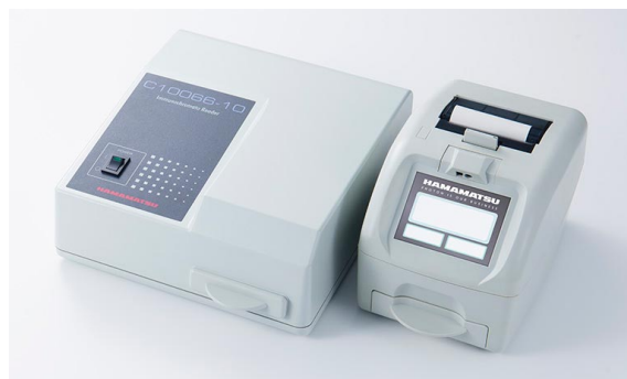
Figura 28: Immagine relativa al lettore immuno-cromatografico Hamamatsu Photonics , modello C10066-10 .
