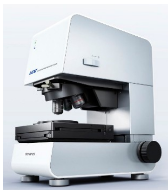
Figura 24: Immagine del microscopio LEXT-OLS4100 , Olympus utilizzato per le analisi di rugosità superficiale.
