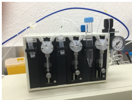
Figura 30: Dettaglio relativo alle tre pompe utilizzate dall' IsoFlow Dispenser per la semina delle strisce reattive.
