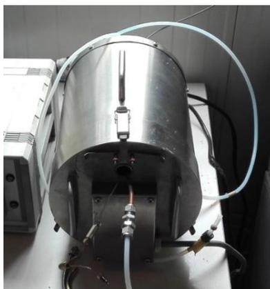
**Figura 22: Scambiatore di calore**
