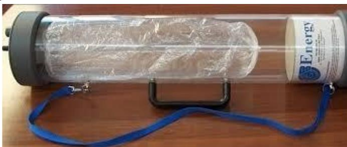
**Figura 1: Pompa a vuoto per il campionamento secondo il principio del polmone**
